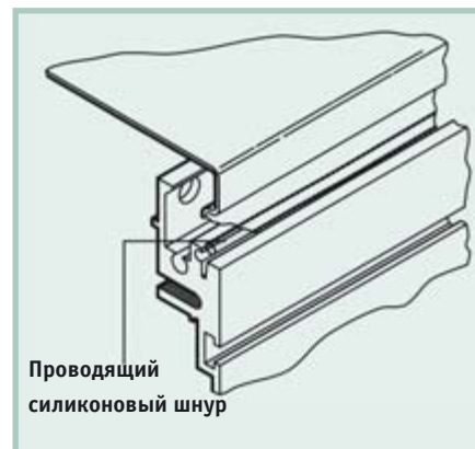
Рис. 6. Прокладка в виде проводящего силиконового шнура
