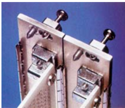
Рис. 5. Лицевые панели модулей и прокладка между ними
